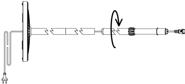
Etape 5 : Fixez l'assemblage des têtes sur le tube supérieur puis serrez légèrement à l'aide de la clé Allen. Ne bloquez pas les vis avant l'étape 7.
